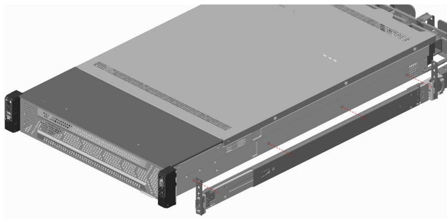
图 3-20 机箱导轨内轨安装
